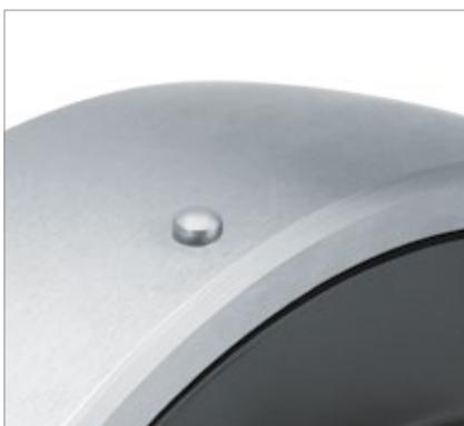
3. Per evitare la rotazione dell'anello esterno bombato del cuscinetto ma garantirne comunque la orientabilità è presente un PIN di bloccaggio sulla sua superficie esterna.
