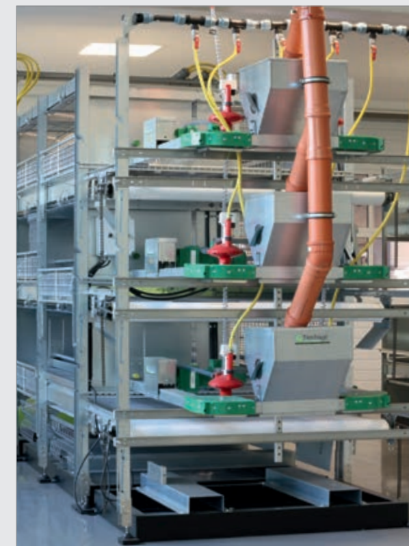
Attrezzatura di alimentazione in un sistema a voliera
