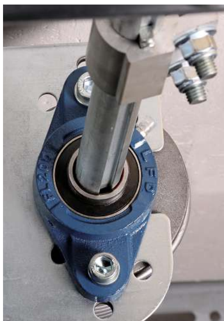
Bild 2: Das Flanschlager für Sektionaltore ist direkt an der Seilrolle montiert.
